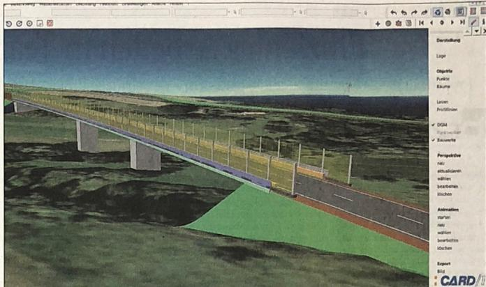
Der CARD/1 Brückengenerator unterstützt den BIM Planungsprozess. Fotos (2): IB&T Ingenieurbüro Basedow & Tornow GmbH
