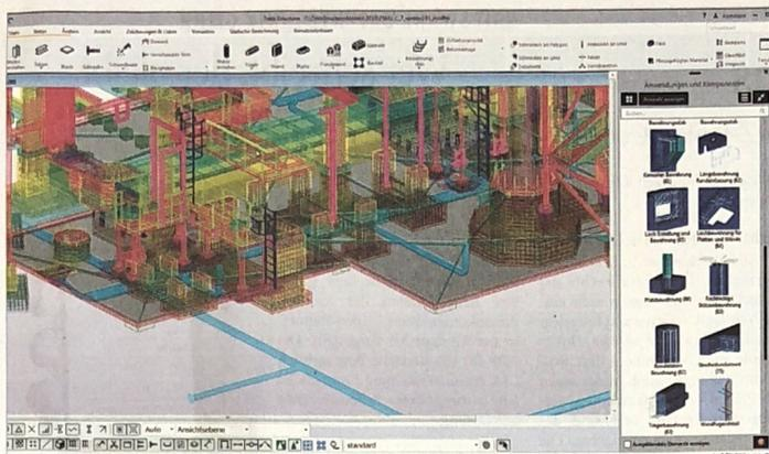
Eine detaillierte 3D-Bewehrungsplanung (hier: BIM Software Tekla Structures) ist erst ab einem Entwicklungsstand von mindestens LOD 400 möglich.
