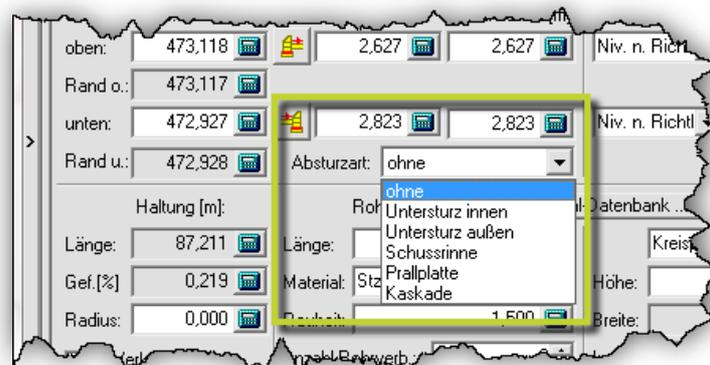
Innerhalb des Längsschnittes sowie der Schachtskizze erfolgt eine entsprechende grafische Darstellung der gewählten Absturzart.
