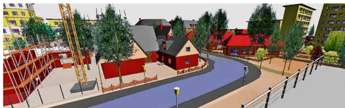
Modifizierte CARD/1 Kanal-Toolbox, hier ein realistisches Abbild der Überflutungsfläche. Hält der Bordstein des Gehwegs dem Wasser stand?
