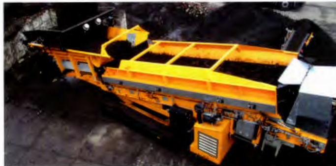
Das raupenmobile Sternsieb 2-ta17 hat einen großen, ansteigenden Bunker und ist mit dem neu entwickelten Vibrorost bestückt.
